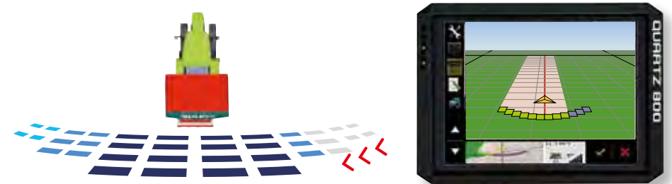
Jos levitysleveyttä pienennetään esimerkiksi viimeisen ajokerran aikana, lohkot sulkeutuvat automaattisesti jäljellä olevan levitysleveyden mukaan (tässä 3 lohkoa oikealla puolella sulkeutuvat)
