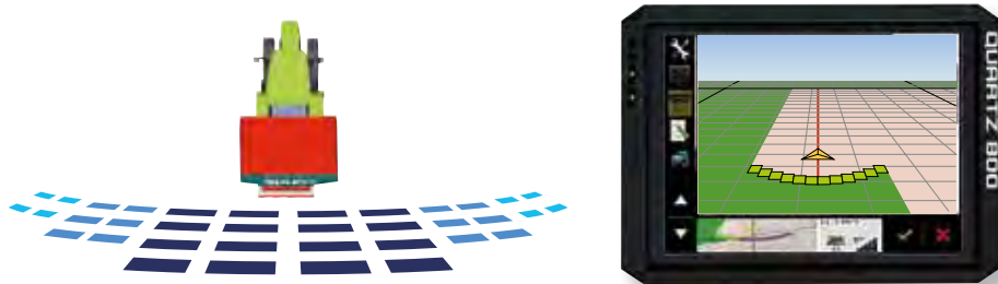
ISOBUS ECONOV ohjaa 12 samanlaista lohkoa millä tahansa työleveydellä (tässä täydellä työleveydellä 12 lohkoa on auki)
