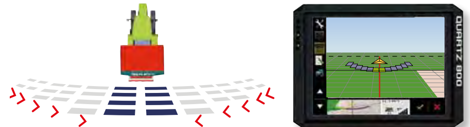
Suorassa päisteessä, ennen levitysalueelle tapahtuvan levityksen kaikkien lohkojen sulkeutumista vain 2 keskimmäistä lohkoa jäävät auki ... näin levityksentarkkuus kaarella on paras mahdollinen
